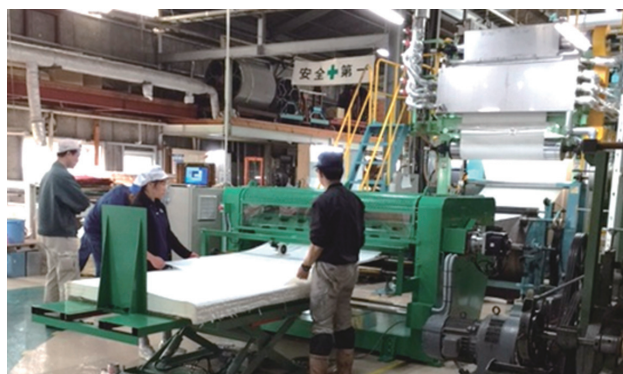
導入設備：NC シングルカッター&amp;テーブルリフター
