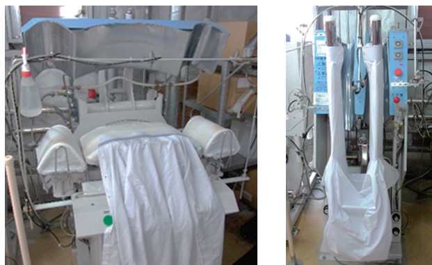
導入設備：カフスプレス(左)、スリーブプレス
