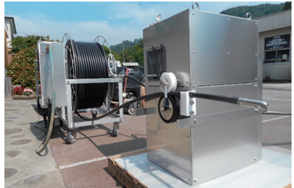
設備機械：排水管エア洗浄システム
