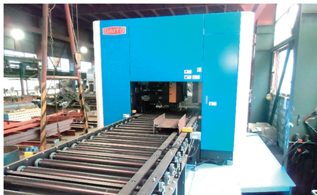
導入機：H型鋼自動開先加工機
