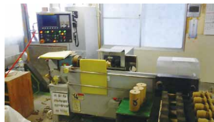
導入したCAD/CAMソフトと連携する碍子専用新型NC旋盤
