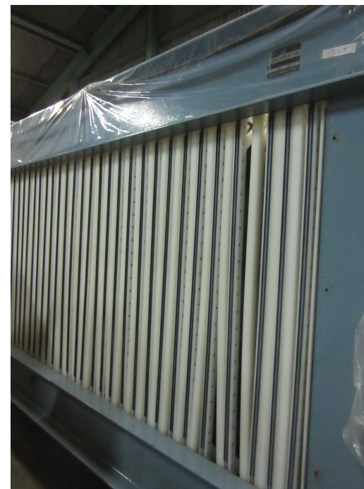
◀ 新型藪田式自動圧搾機の圧搾板とろ過板
