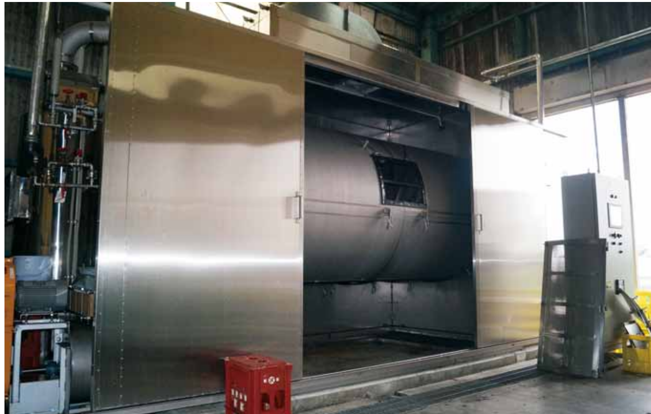
全自動で作業を効率化した製麹設備
