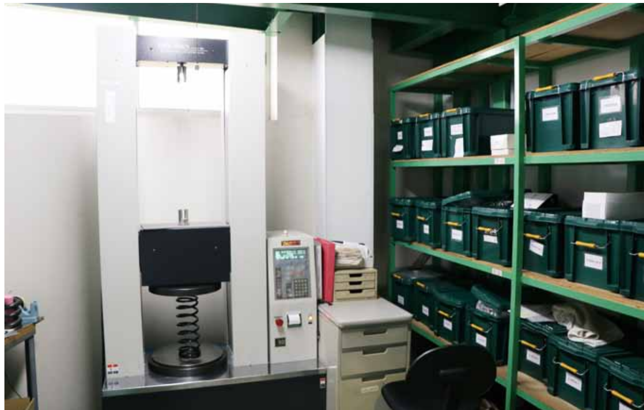
10トンの荷重まで対応可能な測定機
