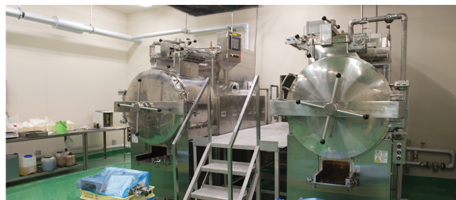
▲設備投資した蒸練機。従来型の 2 ～ 2.5 倍の製造能力をもつ。
