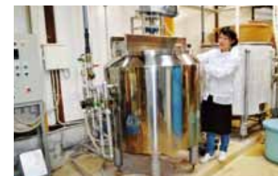
発酵タンクの導入で発酵に必要な60℃を安定的に管理できるようになった
