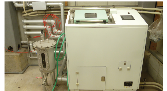
▲水工ゼクター方式 真空乾燥処理装置。みかん以外にも果物や野菜を粉末化できる。
