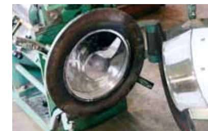
内部が着脱可能な構造で原料ロス低減に
