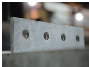
鉄骨同士をつなぐのに必要な孔。高層ビルともなれば、小さな誤差が大きなズレになりかねないため、かなりの精度が要求される
