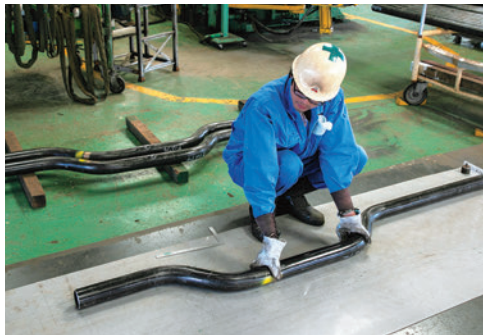
チューブを曲げる加工はボイラ製造の必須工程である
