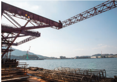
工場に隣接した岸壁。重量物であるボイラを大型クレーンを用いて直接運搬船に積み込める
