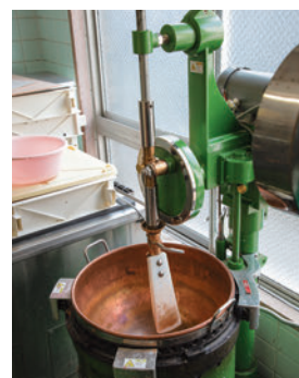
導入した自動餡練り機。作業が自動化されたことで、職人が製品の製造に時間を使えるようになった
