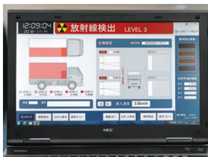
放射能検知器のモニタリング画面。従来はデスクトップ型パソコンであったが、移動が容易なノート型パソコンに対応するようソフトウェアを改良した（写真はデモ画面）
