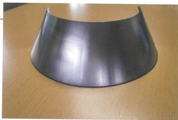
【NC 自動制御によるコニカル曲げ加工】
