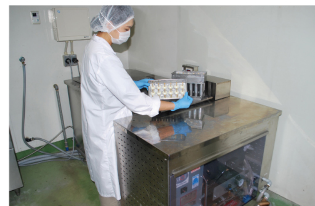
▲今回増設したアイスバー製造装置。牛乳やシロップをベースとしたアイス液を冷やし固める
