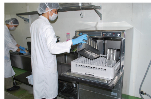
▲導入した凍結缶洗浄機。以前は他の器具と兼用の洗浄機だったため導入によって時間のロスが減少
