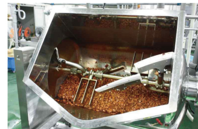
▲今回導入した冷却機能付き真空ニードラー釜
