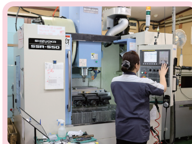
半導体製造装置関連部品の仕上げを行うマシニングセンター
