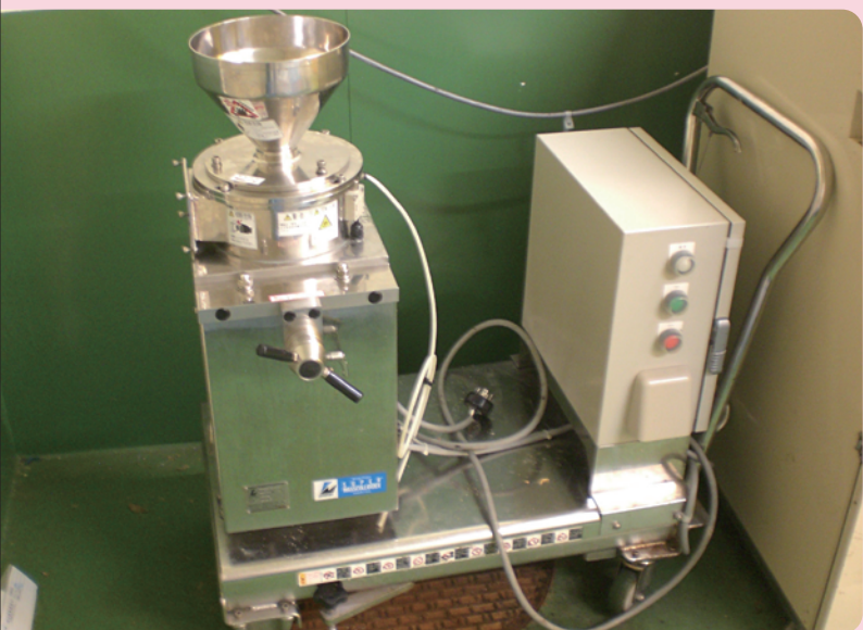
乾燥したB級野菜を微粉碎する粉末機
