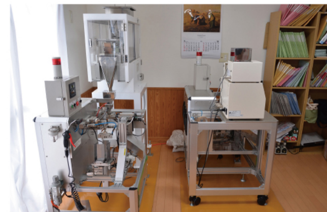
▲今回導入したパッキング装置。左の機械が重量、右の機械が粒数を自動計測して袋詰めを行う
