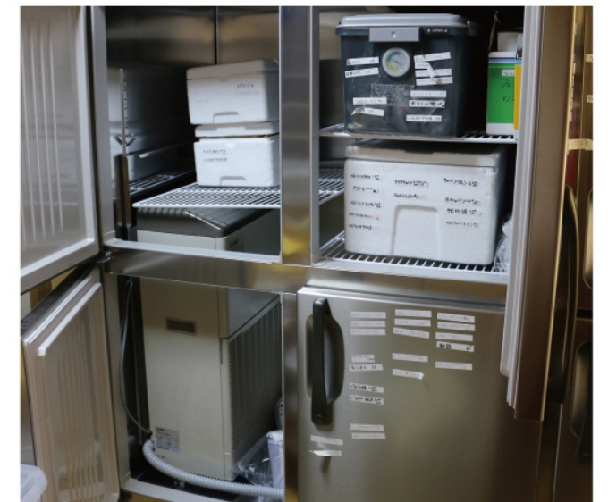
▲保管中の発芽を防ぐために庫内に除湿機を組み込んだ種子専用保冷库。廃棄ロスの削減や発芽率の向上などの効果が出ている
