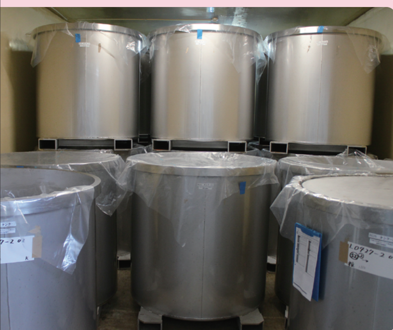
みそ仕込工程で用いるステンレス製発酵タンク
