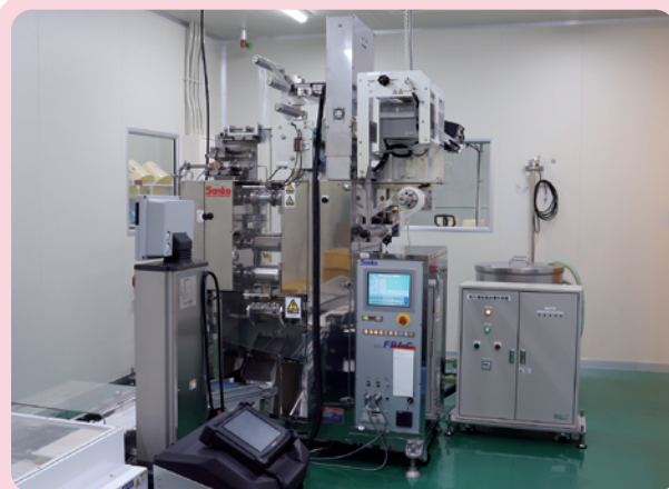
平成25年度導入のスパウト付パウチ自動充填包装機
