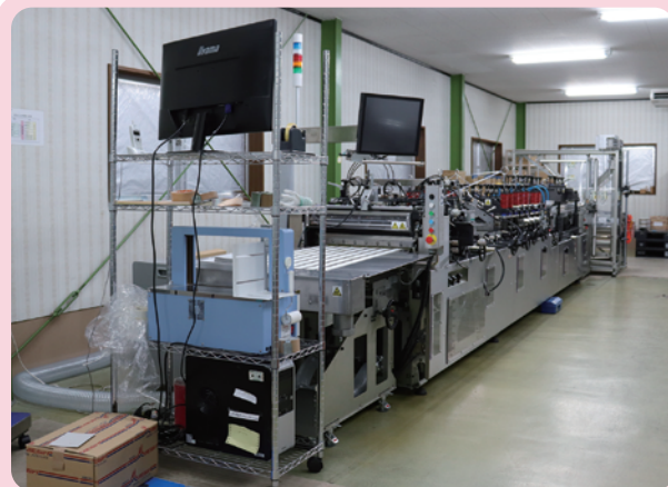
平成29年度同補助事業で導入した三方製袋機
