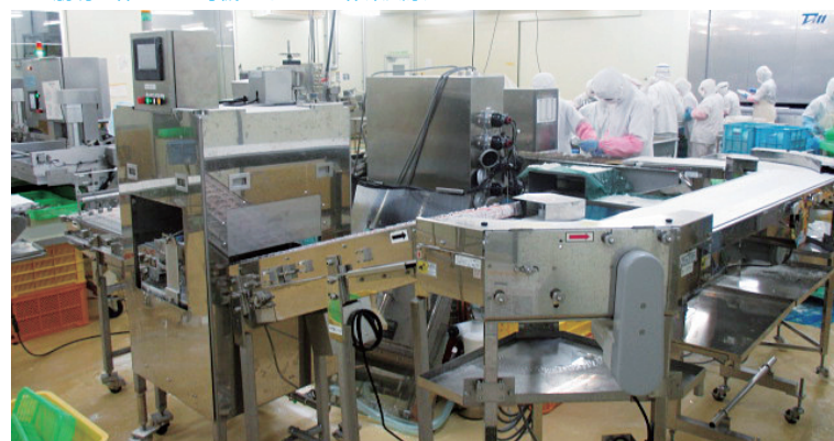
工程間の機械と機械を接続して作業効率を改善
