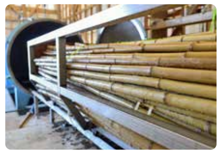
湯煎・殺菌し、乾燥させた真竹に竹材真空注入装置を使って薬剤を注入。防虫加工を行います。
