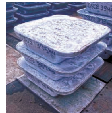
選別した材料から製造したアルミ二次合金
