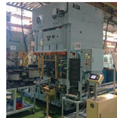
搬送装置搭載プレス機械全景
