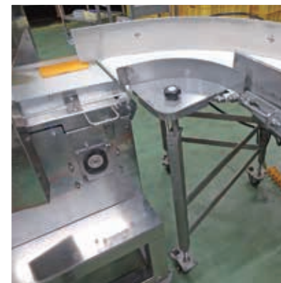
ライン接続コンベア
