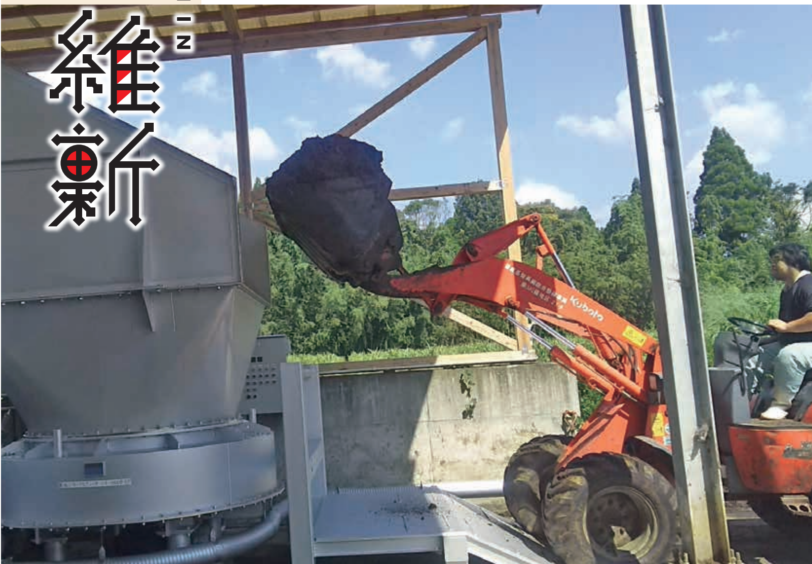
定量供給機に牛糞を投入
