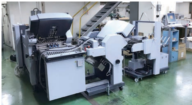
高度な機械制御技術を用いた紙折り機を導入
