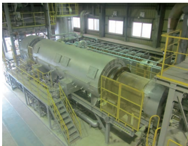
導入したフライアッシュ加熱改質装置
