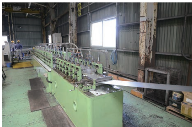
導入した角スタッド製造設備
