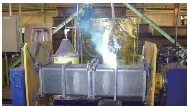
自動溶接ロボットでコア部分の溶接
