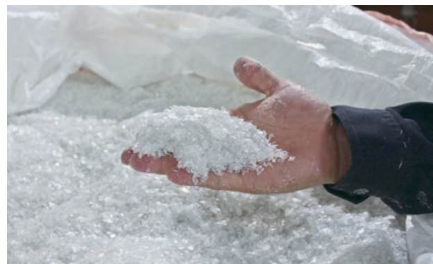
新しい比重選別機は純度の高いPETフレークの生産に寄与している
