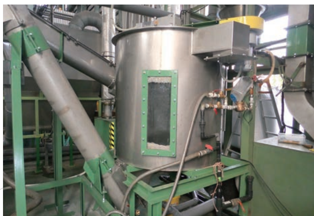
試作開発した縦型の比重選別機
