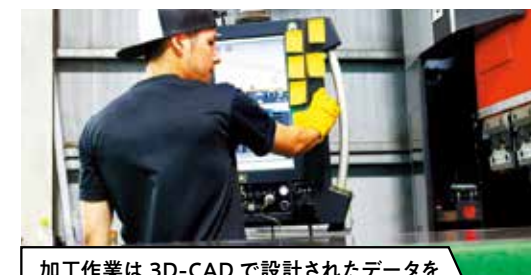
加工作業は 3D-CAD で設計されたデータを見ながら操作する
