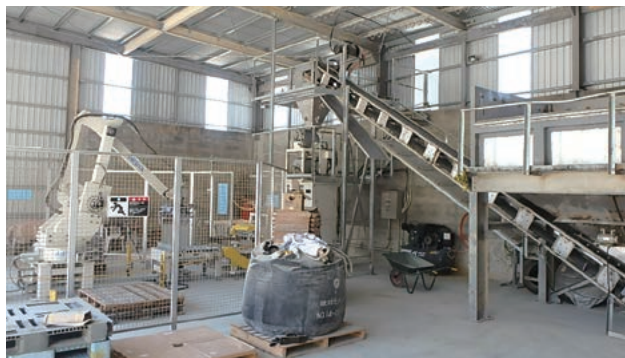
導入した砂(海)・砂利用自動計量包装設備(写真奥)とロボットパレタイザ設備
