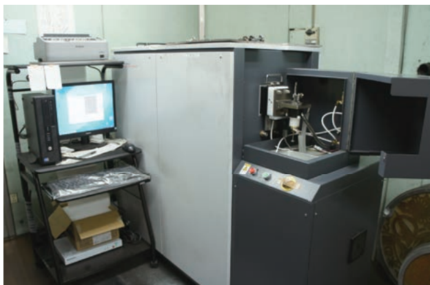
鋳物の材料分析の精度を上げる「最新発光分析装置」
