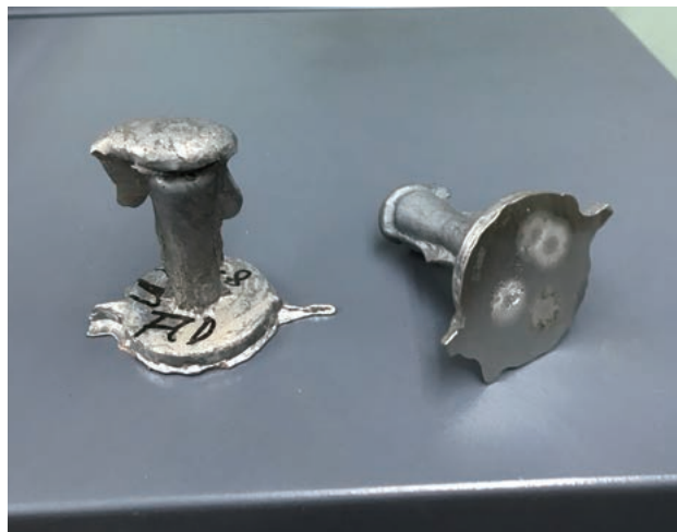
小さな金属片「テストピース」の表面に光を当てることで成分を詳細に分析
