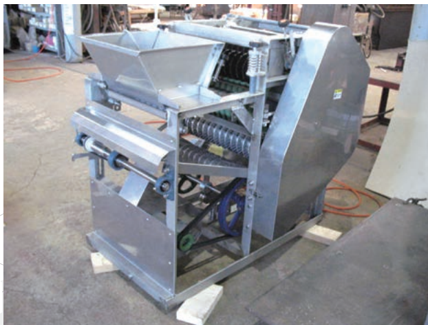
落花生の皮をむくロール式脱皮機
