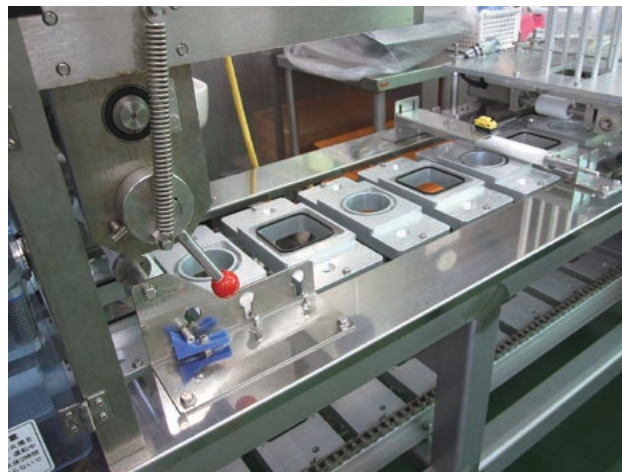
角型・丸型両方に対応可能な間欠包装機
