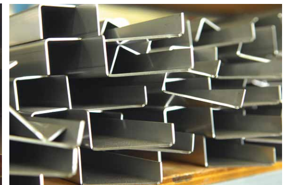
窒素によるレーザー切断面
