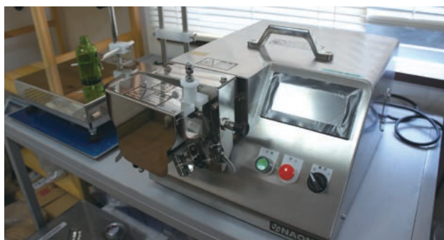
パズル充填機で化粧水やオイルの充填作業を効率化
