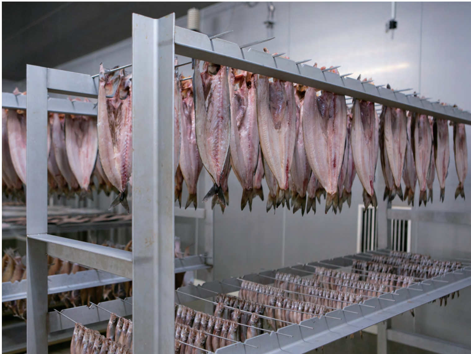
窒素封入温風室の専用ラック。窒素がムラなく当たるよう工夫されている
