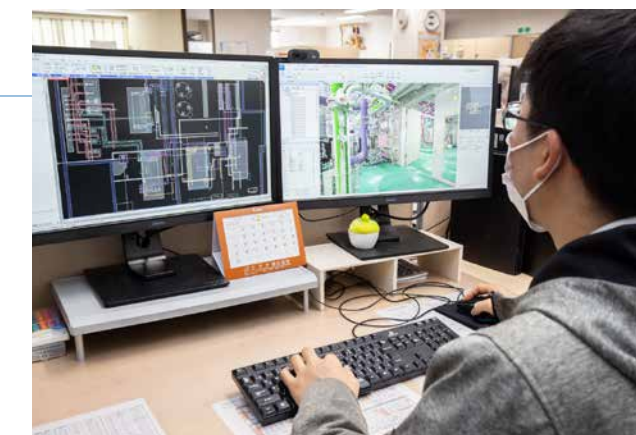
3Dスキャナーで取り込んだ室内のデータの中から不要なものを削除し、より正確なデータを制作する。
