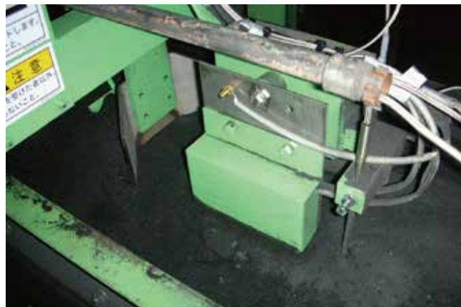
鑄型砂の状態をセンサーで感知
