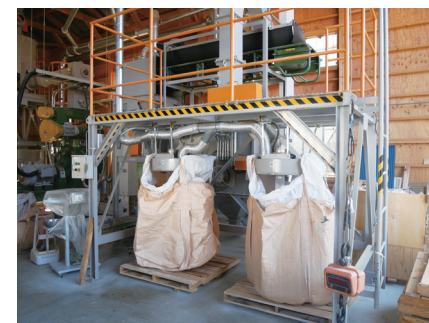
廃材を木質ペレットにする工程
