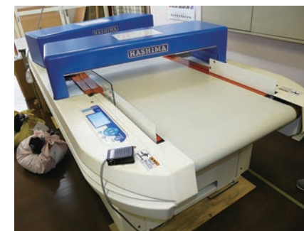
金属探知機で納品前に縦横二重で確認
