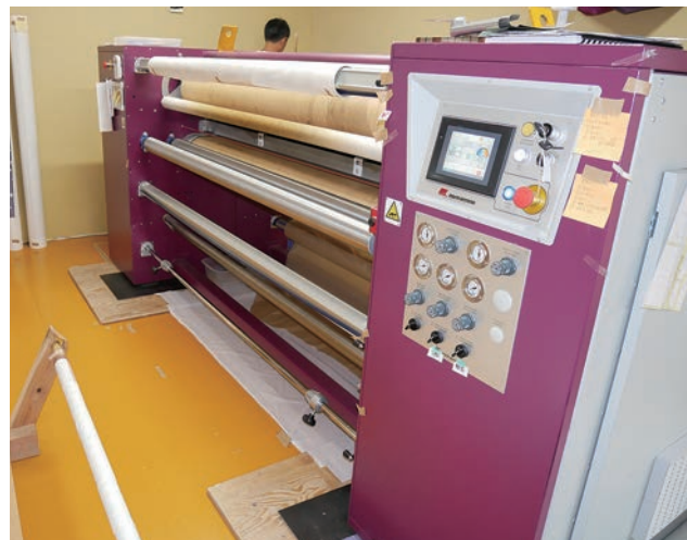
導入した熱転写システム
