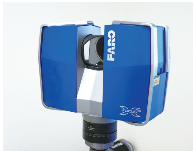
導入した3Dレーザースキャナー
