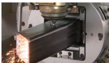
レーザー光線で切断する
