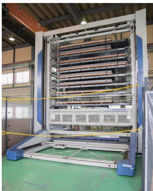
セルローダーストッカ(自動材料棚)は8段まで収納可能。
