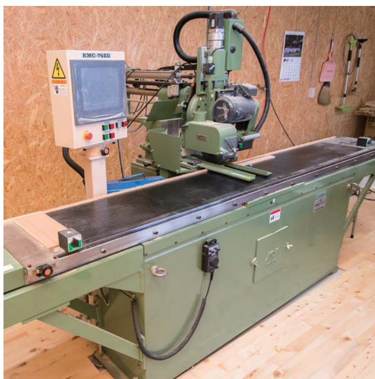
導入した機械で組子の「骨」になる部分を自動切削する。
